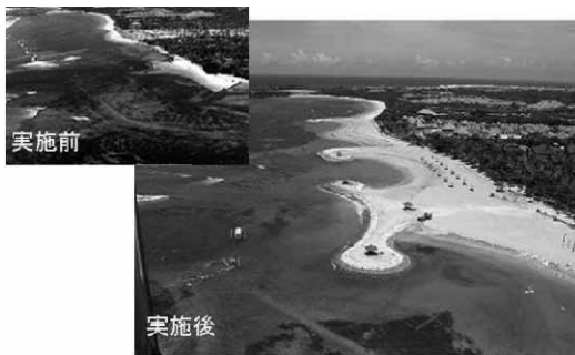
養浜 + ヘッドランドによる砂浜の復元 (ヌサダア)
